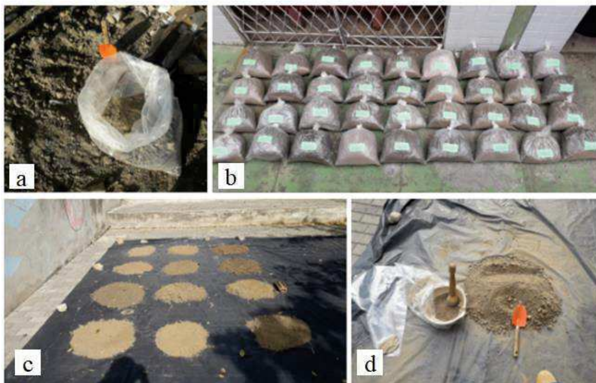
Figura 11. Coleta e preparação das 36 amostras de solo coletadas na camada de cobertura.
