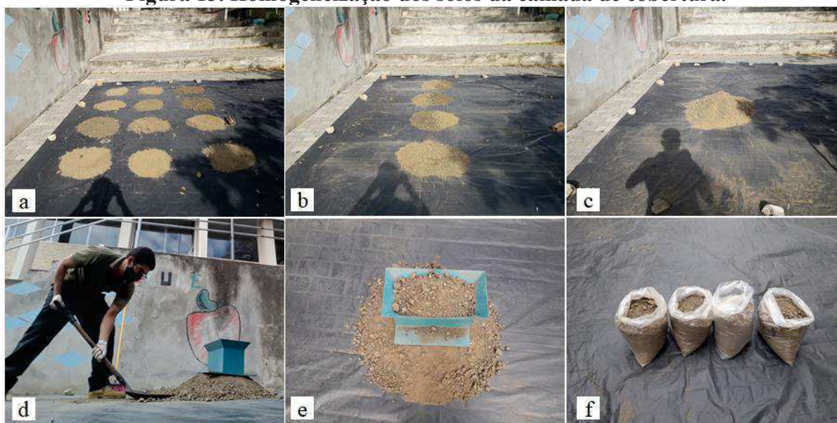
Figura 13. Homogeneização dos solos da camada de cobertura.
