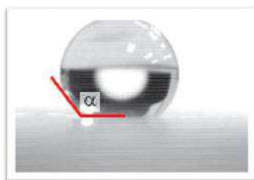
Figura 11 - Imagem do ângulo de contato formado por uma gota de água em uma superfície hidrofóbica.
