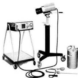
a) Detector resfriado a nitrogênio líquido, sistema de varredura óptico/mecânico, peso total de 37 kg.
