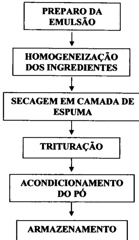
**Figura 3.4** - Fluxograma do processamento para obtenção do figo-da-índia em pó
