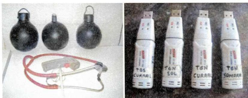
**Figura 8 -** *Globo negro, estetoscópio, termômetro de superfície, termômetro de Mercúrio e datalogger digital modelo HT -500*
