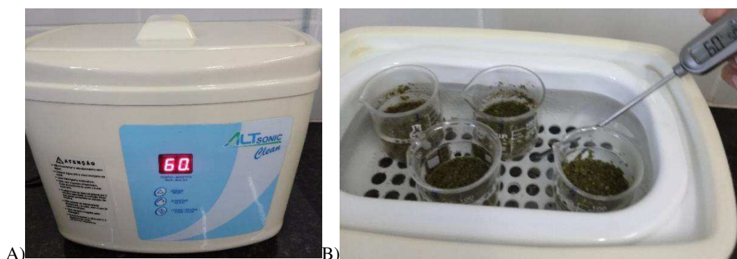
Figura 5: A) Aparelho de ultrassom Alt Sonic Clean; B) Extração de bioativos de T. subulata em ultrassom.
