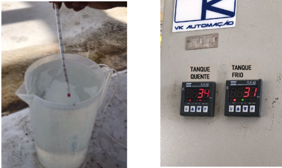
Figura 12: Validação do dispositivo de medição
