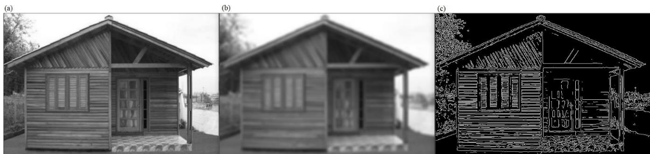
Figura 4 – Imagem original (a), imagem filtrada (b), detecção de bordas de Canny (c).
