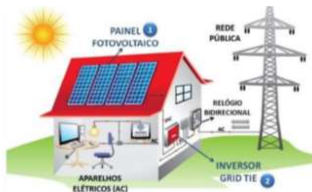
Figura 4 – Sistema fotovoltaico on-grid
