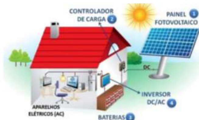
Figura 3 – Sistema fotovoltaico off-grid
