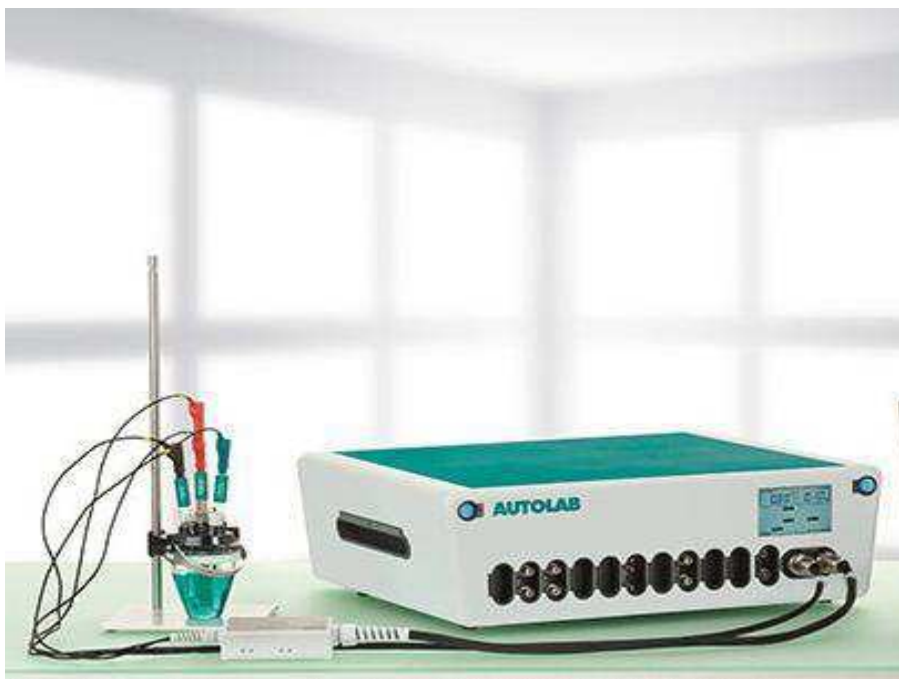
Figura 8: Potenciostato/ Galvanostato da Methrom, modelo 302 e da célula eletroquímica a três eletrodos.
