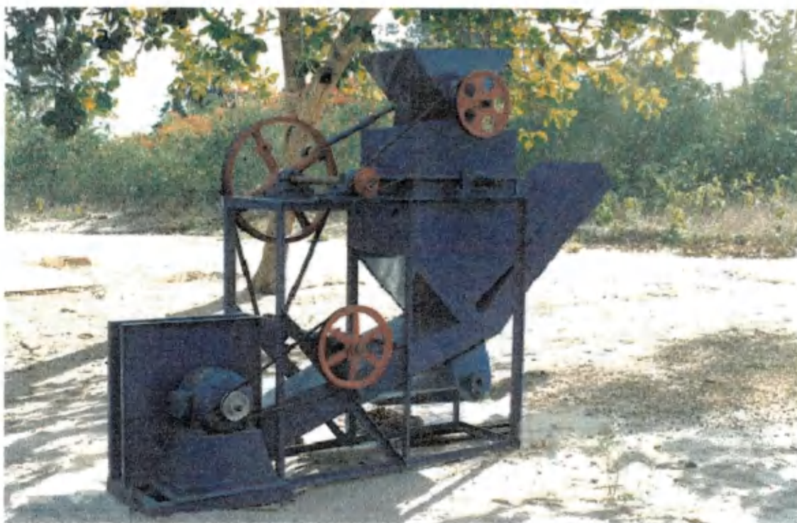
Figura 2.5. Máquina de descascamento de amendoim desenvolvida pela Embrapa Algodão. Fonte: ARAÚJO (1999).
