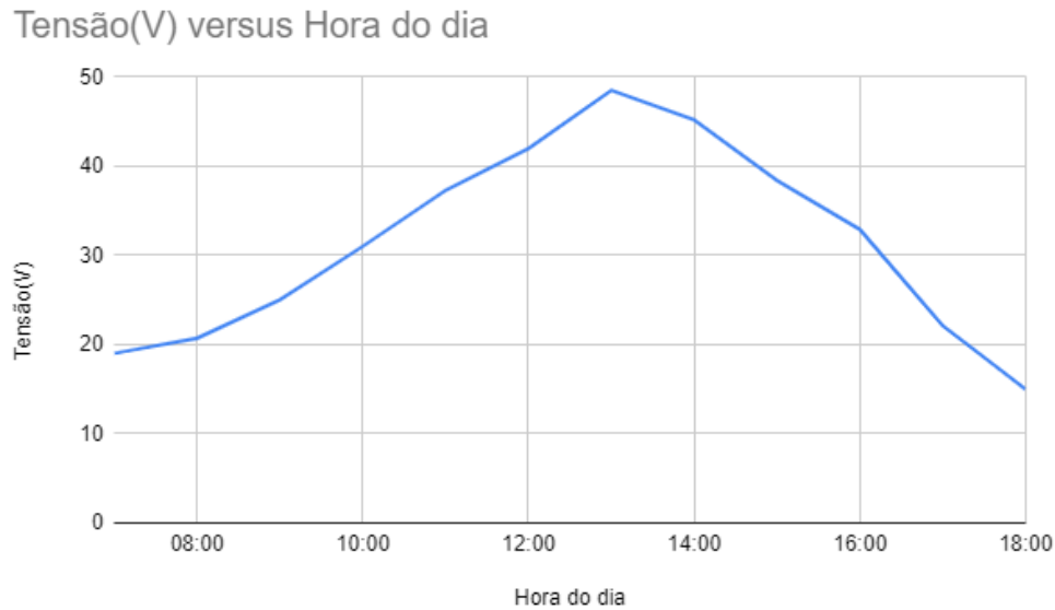
FIGURA 10: GRÁFICO DA TENSÃO GERADA X HORA DO DIA.
