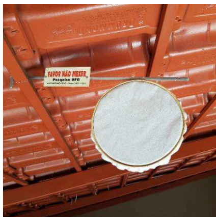
Figuras 1 e 2. Sistemas de monitoramento passivo adaptados utilizados na pesquisa. Respectivamente: SISCO e PUF.
