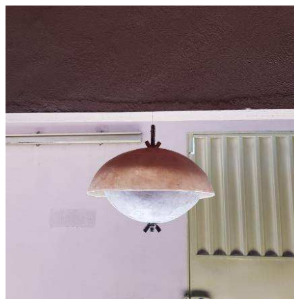
Figuras 1 e 2. Sistemas de monitoramento passivo adaptados utilizados na pesquisa. Respectivamente: SISCO e PUF.
