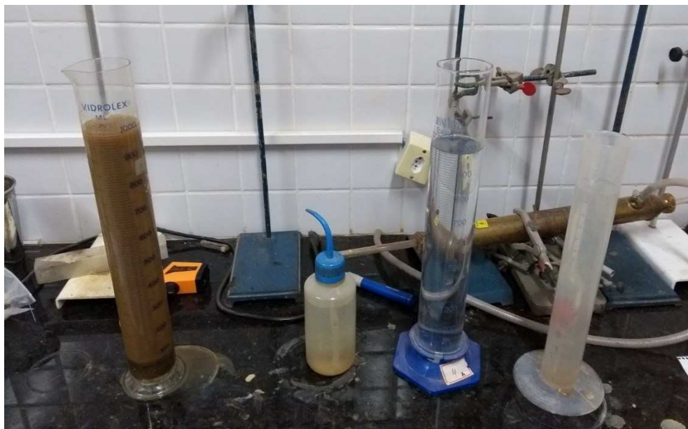
Figura 24 – Procedimento de sedimentação
