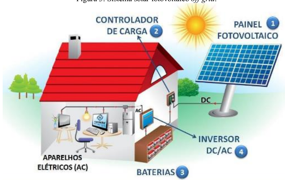
Figura 3: Sistema solar fotovoltaico off grid .
