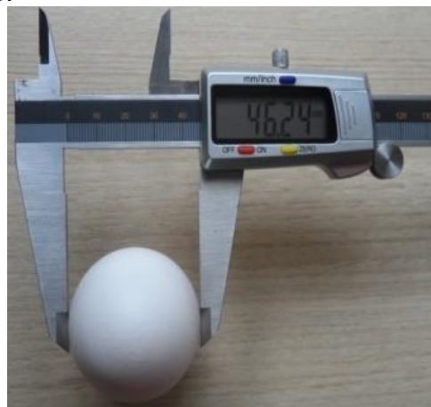
Figura 1. Procedimento de coleta das medidas dos ovos: A. eixo maior e B. eixo menor
