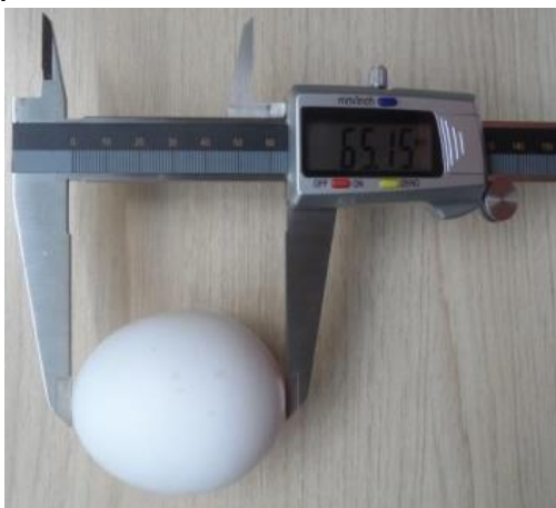
Figura 1. Procedimento de coleta das medidas dos ovos: A. eixo maior e B. eixo menor
