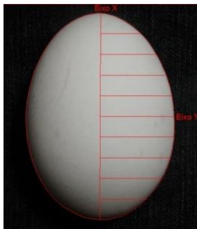
Figura 3. Imagem processada para a determinação das dimensões das coordenadas X e Y.
