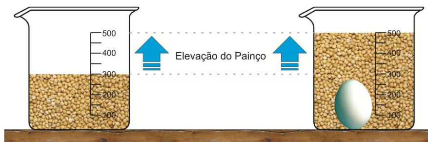
Figura 4. Determinação do volume de ovo por meio do método de imersão.
