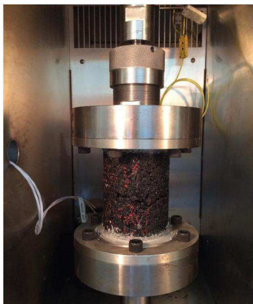
Figura 21 - Equipamento de tração direta
