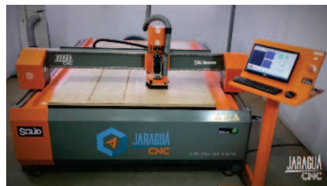
Figura 20. Maquinha CNC para corte de MDF Fonte (Router CNC SOLID)
