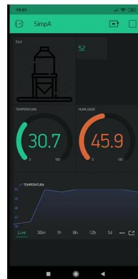
Figura 11. Telas de monitoramento da temperatura, umidade e nível de grãos medidos.
