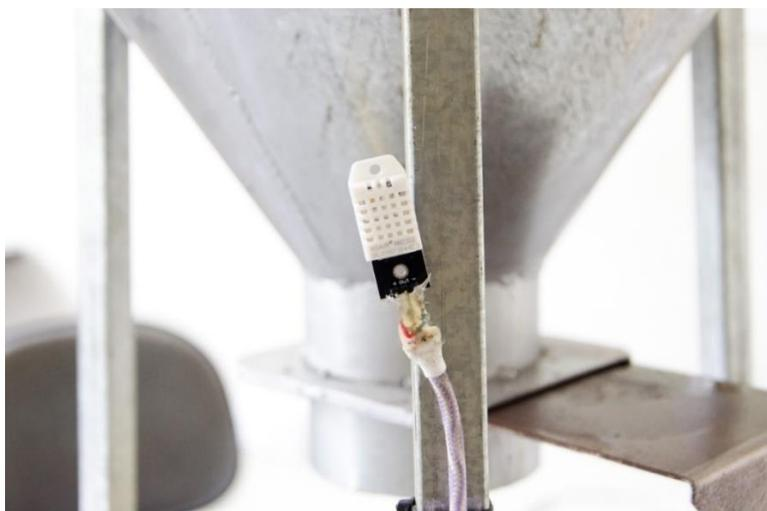
Figura 3. Sensor de umidade externo.
