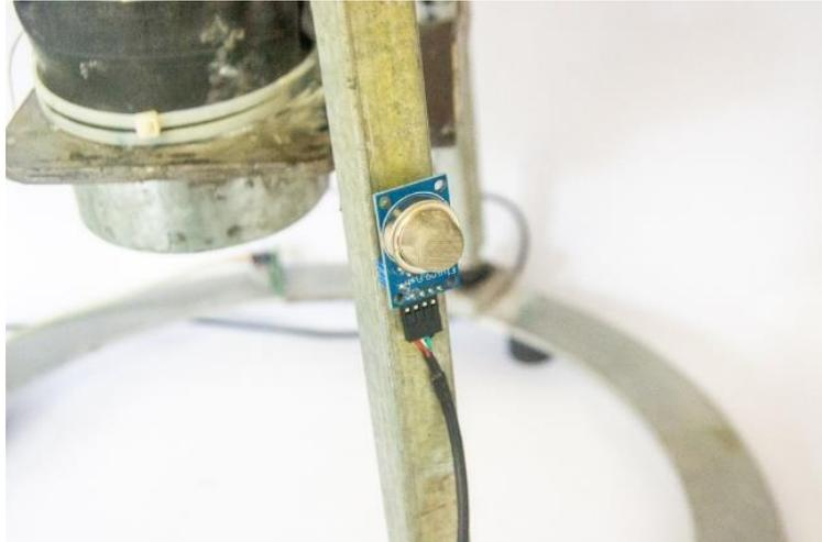
Figura 5. Sensor de gases.
