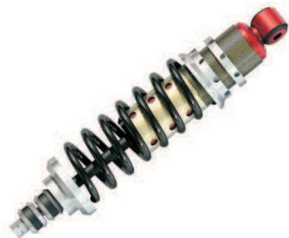
FIGURA 18: Exemplo de um amortecedor
