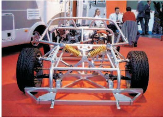
FIGURA 9: Exemplo de um chassi de gaiola
