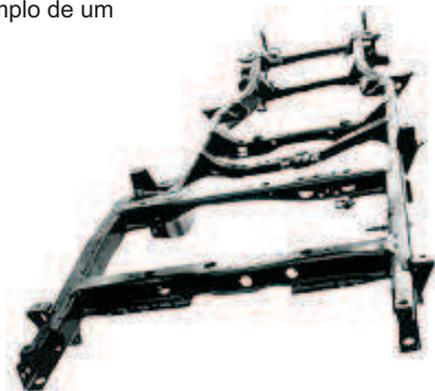
FIGURA 13 E 14: A esquerda e a direita. Exemplos de Chassi de longarinas
