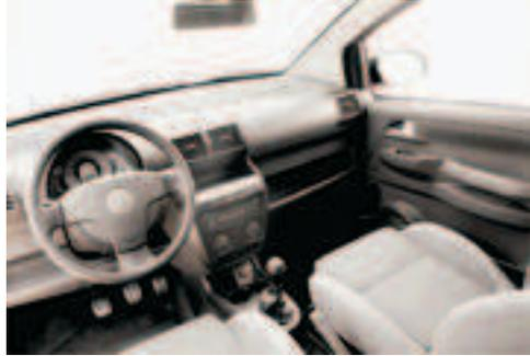
FIGURA 27: Parte interna do cross fox. O teto é fabricado com fibra de carauá.
