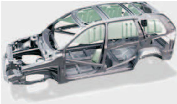
FIGURA 11: Exemplo de um chassi de monobloco
