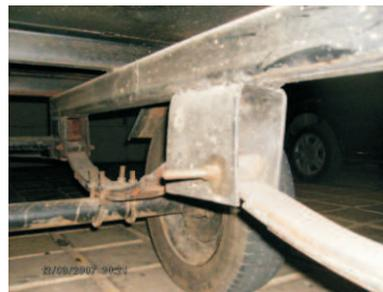
O sistema de amortecimento é muito comum utilizado em reboques, que é molas semi-elípticas paralelas fixadas no eixo
