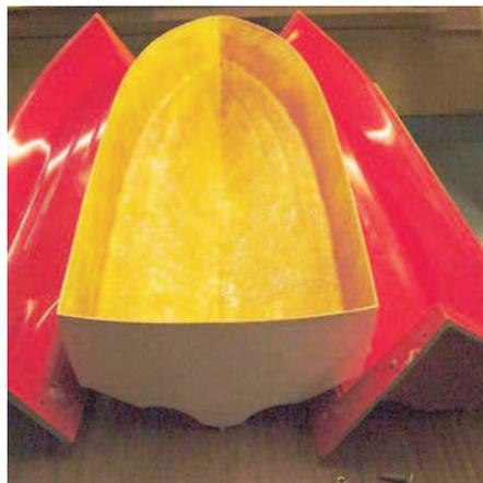
FIGURA 25: Exemplo de laminação de fibra de vidro.
