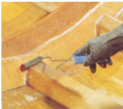
FIGURA 26: Exemplo de laminação Kevlar em embarcações.
