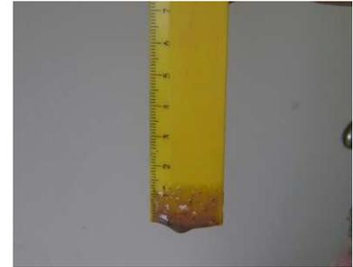
Quando o leite condensado atinge o nível de fervura (105° C), este nível chega a 3 cm, ou seja, uma variação de 1,5 cm.
