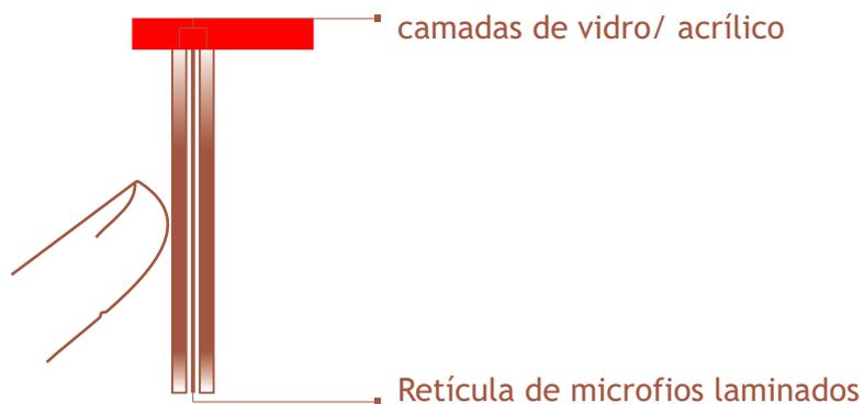
Figura 13: Tela de sensor capacitivo - Adegas elétricas Brastemp
