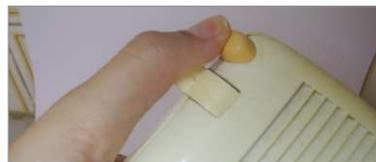
2 -Pressiona-se o botão para folgar o encaixe, e remove-se o misturador
