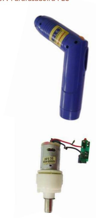
Figura 08: Motor da parafusadeira FLC
