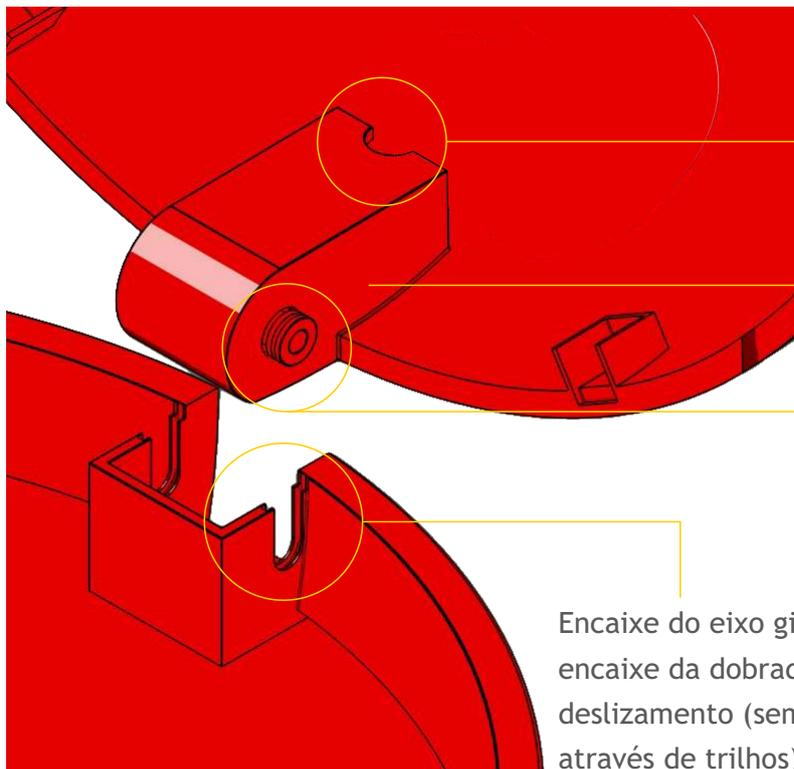
Figura 82: Detalhamento da dobradiça
