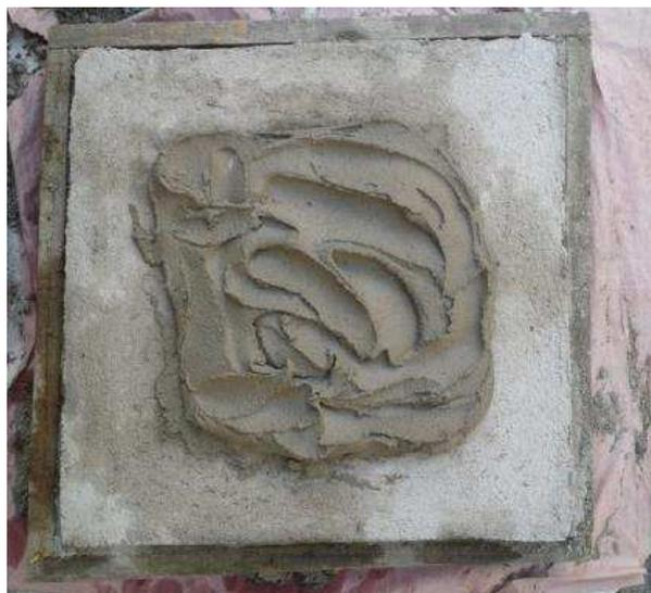
Figura 29 - Aplicação da Argamassa para o revestimento.
