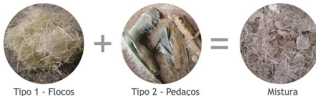
Figura 21 - Mistura de resíduos para construção dos corpos de prova. Fonte: Construção do Autor.
