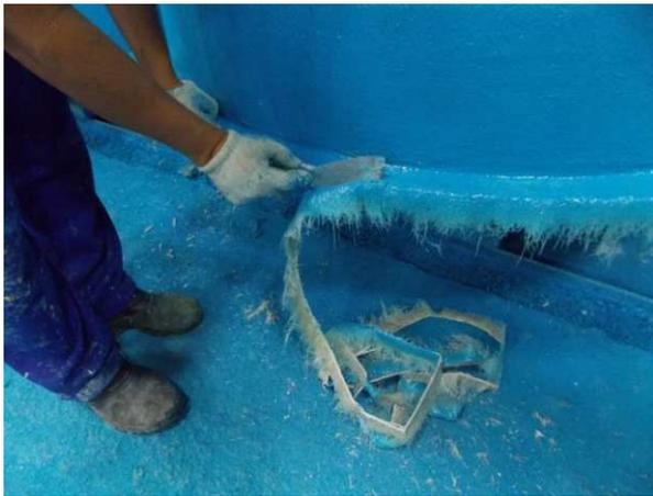
Figura 13 - Aparas das rebarbas da caixa d' água. Fonte: O Autor.
