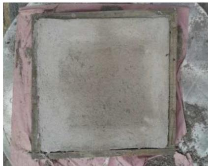
Figura 28 - Parede de alvenaria pronta.
