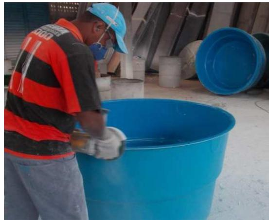
Figura 14 —Lixamento das bordas da caixa d' água. Fonte: O Autor.
