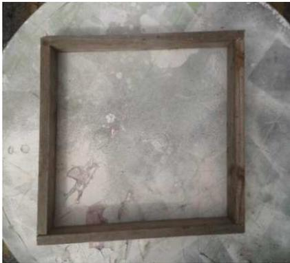
Figura 27 - Moldura de Madeira para estruturação da parede.
