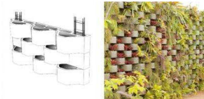
Figura 33 - Bloco PréMoldado zigue-zague.
