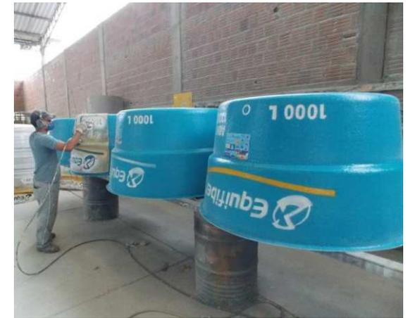
Figura 15 - Pintura dos grafismos nas caixas d' água. Fonte: O Autor.
