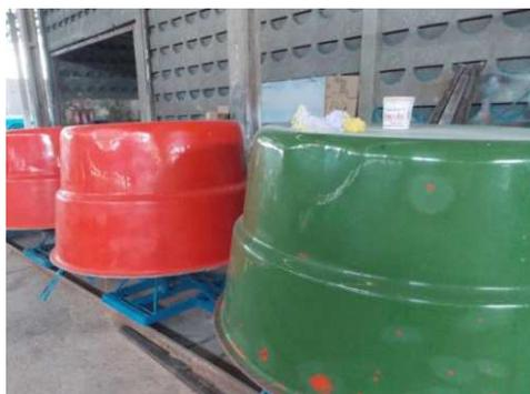
Figura 9 - Matriz n aplicação da cera e álcool desmoldante. Fonte: O Autor.
