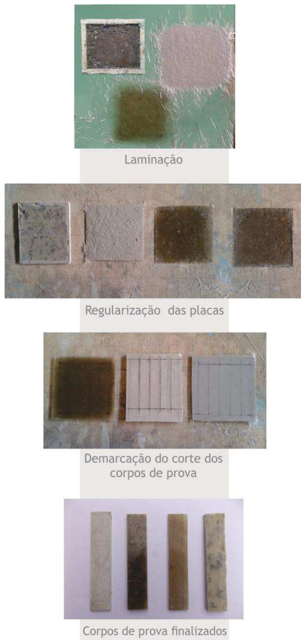
Figura 23 —Construção dos orpos de prova. Fonte: Construção do Autor.
