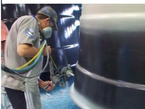
Figura 11 - Laminação do PRFV com processo Sprayup. Fonte: O Autor.
