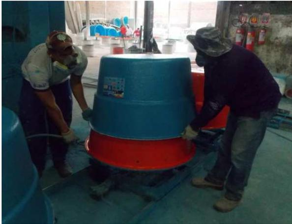
Figura 12 - Desmoldagem de uma caixa d' água. Fonte: O Autor.
