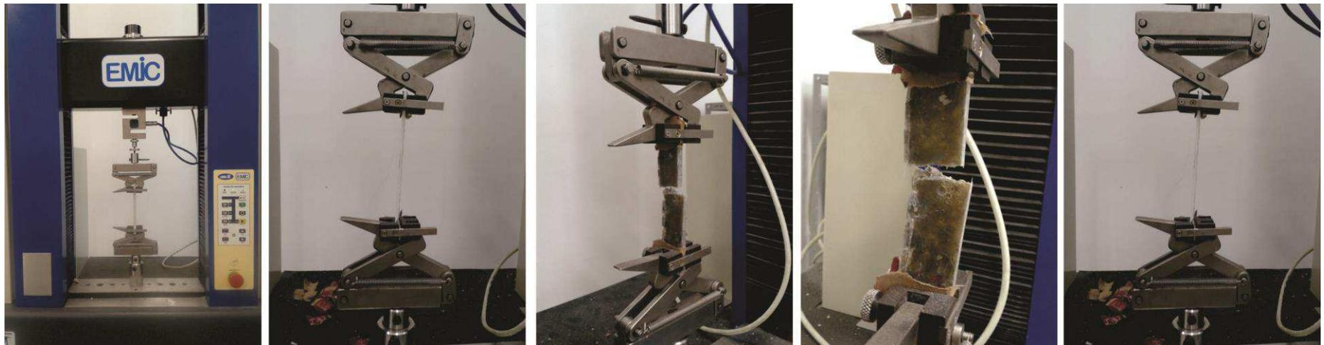
Figura 24 - Corpos de prova sendo submetidos aos ensaio de tração. Fonte: O Autor
