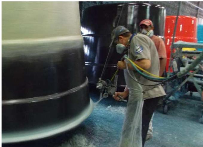
Figura 5 - laminação do PRFV pelo processo de Sprayup.
