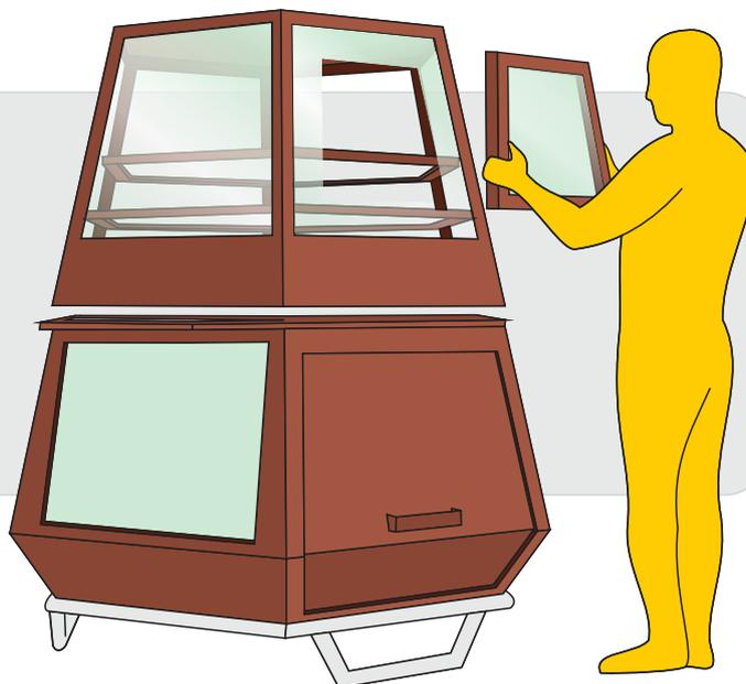
▲ Figura 105- Representação da remoção da tampa da cabine
