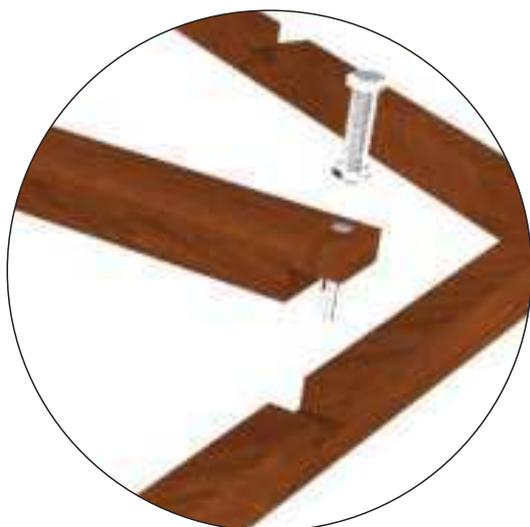
◀ Figura 136 - Corte em L dos eixos que permite o encaixe.
