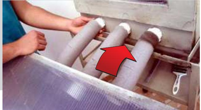
► Figura 36: Conexão dos dutos condutores entre a cabine e o coletor solar.
