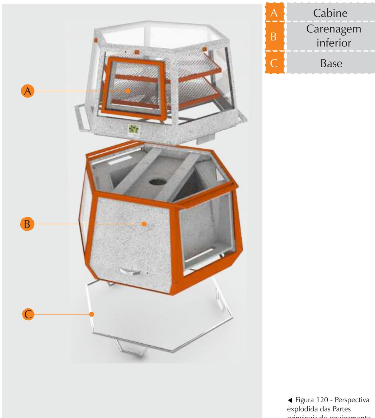
◀ Figura 120 - Perspectiva explodida das Partes principais do equipamento
