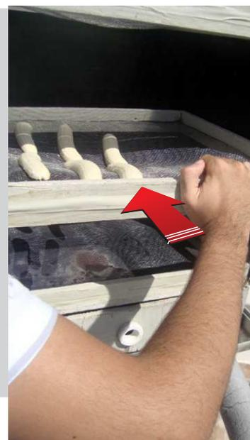
► Figura 40: Empurrando as bandejas para dentro da cabine.
