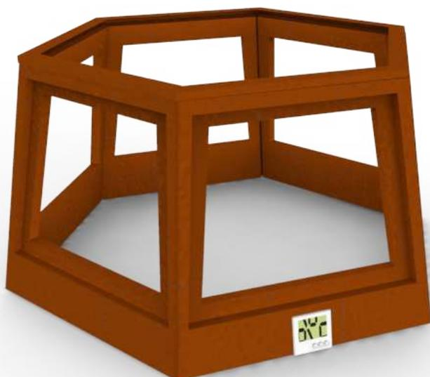
◀ Figura 134 - Carenagem da cabine possui rebaixos para a acomodação dos visores de vidro.
