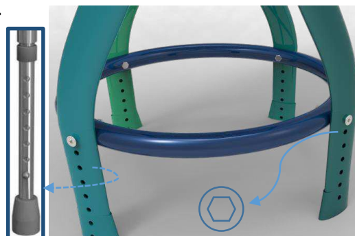
Figura 41: parafusos unem a estrutura ao aro metálico e possibilitam ajustes de altura da estrutura e do apoio para pés. Nas extremidades dos parafusos, há porcas com limites, que travam o sistema. Detalhes: sistema similar e parte superior do parafuso.
