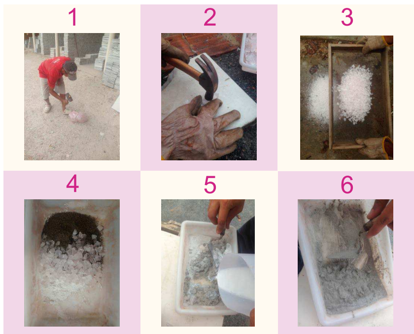
Figura 31 - Processo de fabricação do resolito. Fonte: Autor
