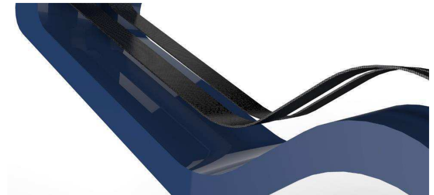
Figura 90- Detalhamento de fixação do velcro no corpo do produto (Fonte: Própria)
