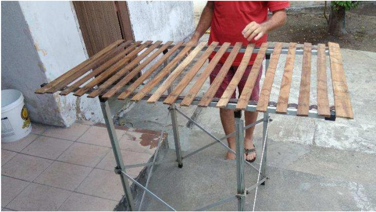
Figura 23: Posicionamento do tampo (esteira).
