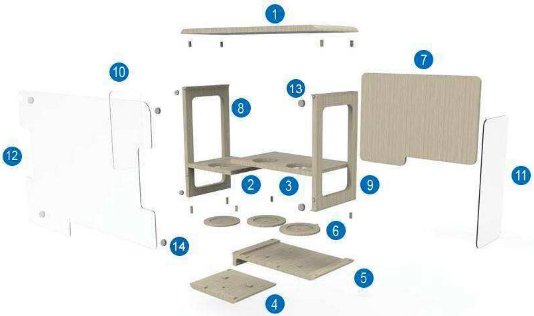
Vista explodida referente a peça que comporta três bonecas
