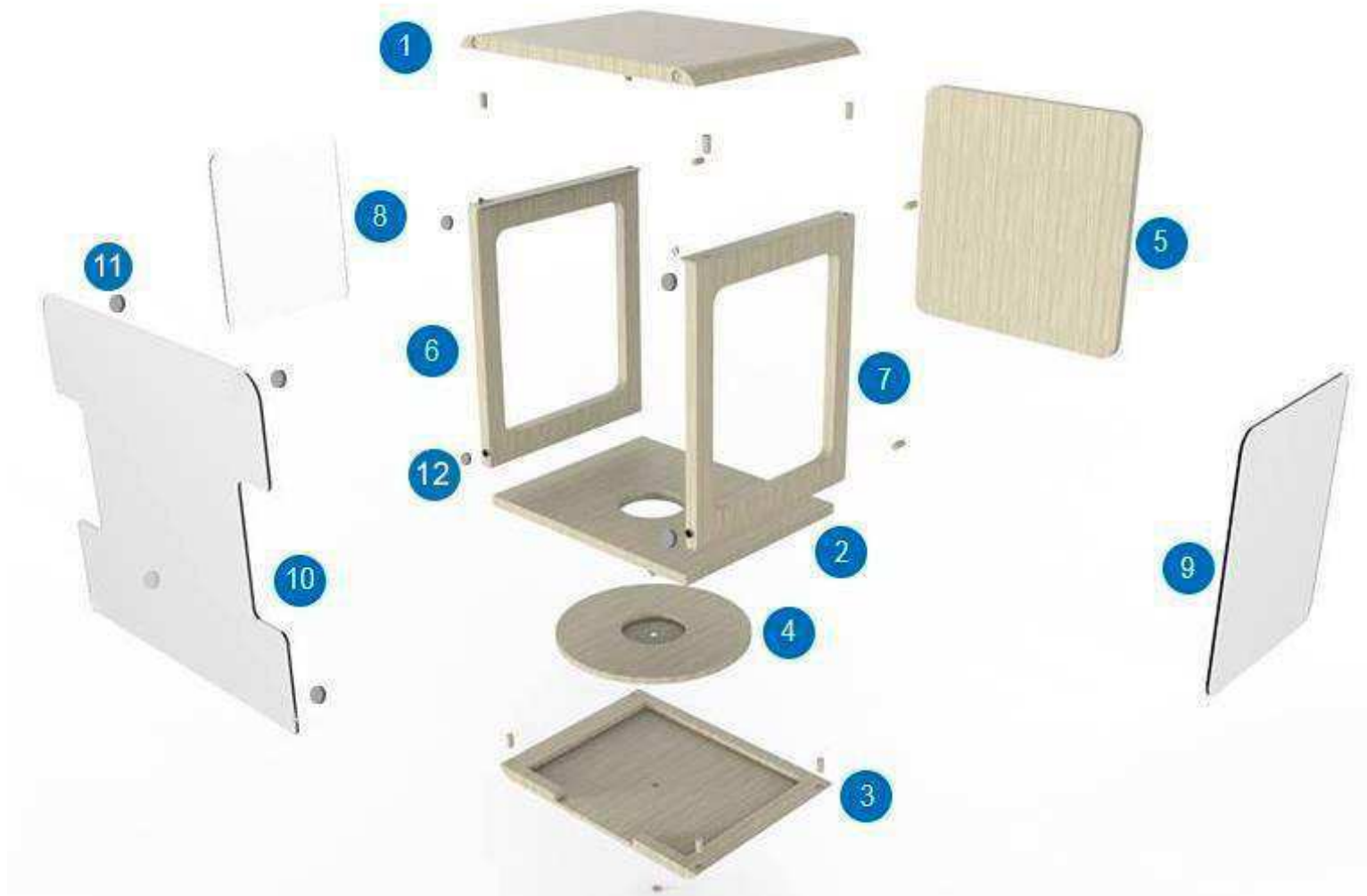
Vista explodida e nomenclatura das peças referente ao nicho que comporta uma única boneca
