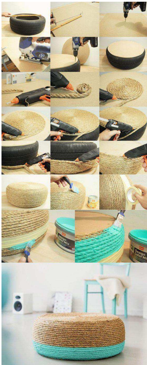
Figura 34 - Passos para construção em casa de um banco com uso de pneu.
