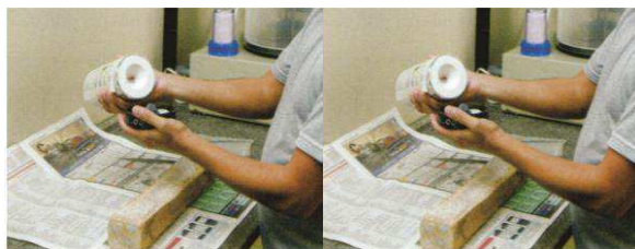
FIG.145: Retirada do excesso de revestimento.
