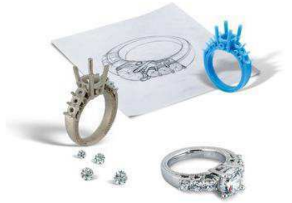
FIG.33: Anel produzido através do processo de fundição.
