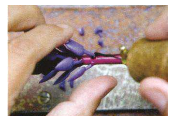
FIG.142: Montagem da árvore de cera.
