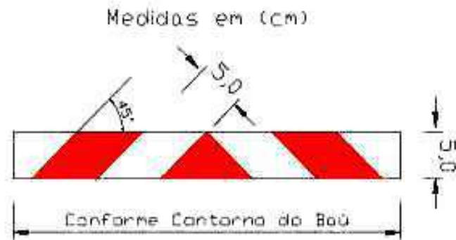
Figura 25 Dimensionamento do dispositivo reflectivo para baús.
