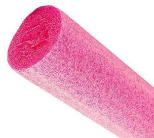
Figura 34: “Macarrão” para piscina confeccionado em espuma de PE.
