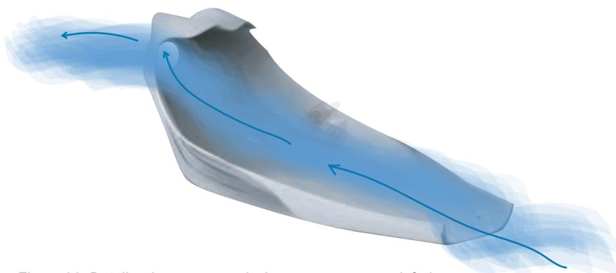
Figura 90: Detalhe da passagem da água na carenagem inferior.
