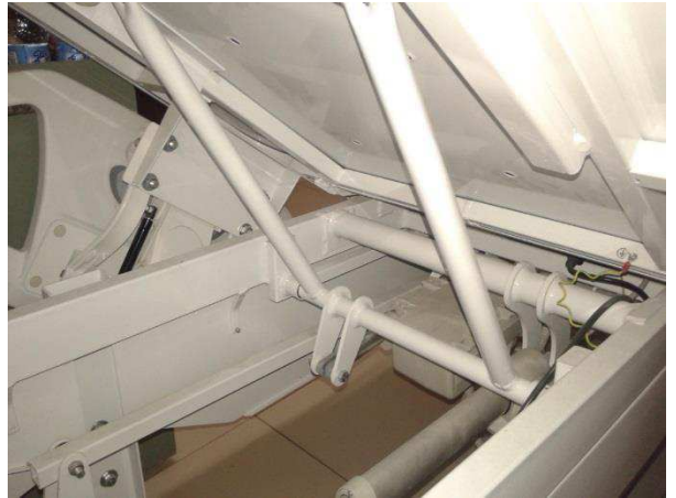
Figura 32: Tubos e corredeiras de roldanas fixadas a plataforma.
