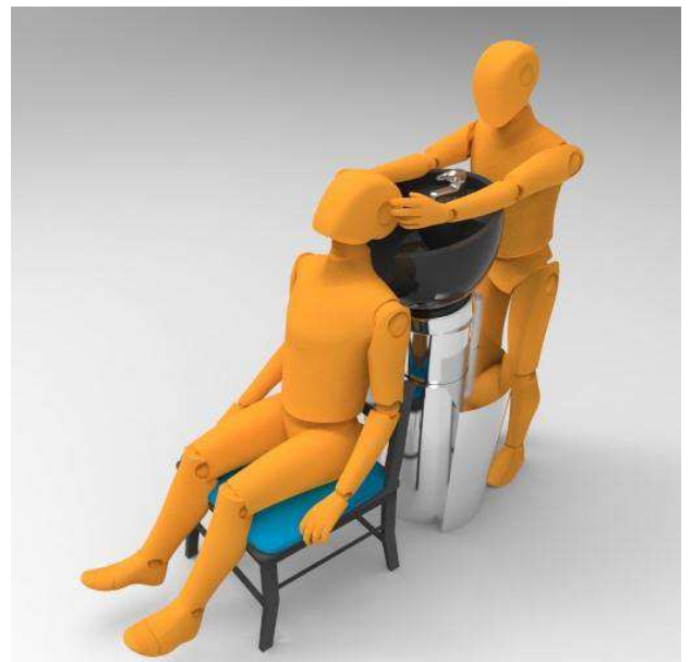
Figura 60: usabilidade com usuário não cadeirante de 1,70 m de altura. Fonte: próprio autor.
