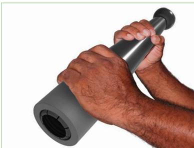
**Tarefa:** em seguida o usuário desenrosca um pouco a porca do corpo do módulo com as duas mãos, para que os “dentes” se abram;
