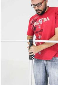
**Tarefa:** Para ajustar a altura da girafa o usuário deve destravar o dispositivo tripé com uma das mãos através do rosqueamento;
