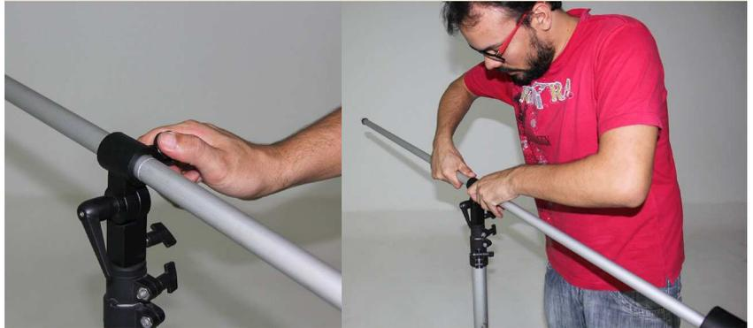
**Tarefa:** Com a haste fixa no tripé, e sua angulação travada, o usuário deverá posicionar a altura desta haste horizontal. Com as duas mãos, o usuário moverá a haste horizontal para frente ou para trás, posicionando-a adequadamente. Em seguida, com uma das mãos, ele irá travar esta haste com o dispositivo de rosca localizado na lateral;
