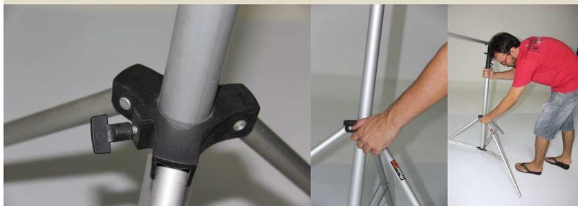
**Tarefa:** Rosquear o parafuso que permite travar e destravar o deslizamento das três pernas do tripé. A outra mão é necessária para segurar, com certa força, a haste principal do equipamento. O usuário irá rosquear o parafuso para destravar e permitir a abertura das pernas do tripé;
