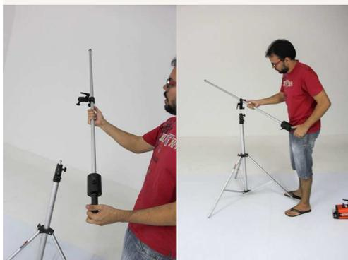
**Descrição:** A haste horizontal da MAKO possui 2,30 m de comprimento, e 4,5g de peso(incluindo o contrapeso de 3kg).
