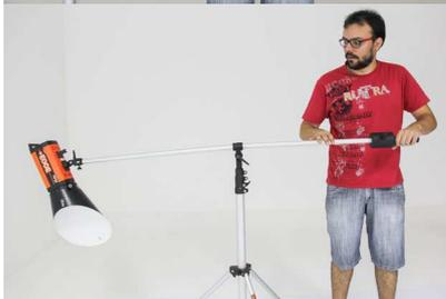
**Tarefa:** o usuário pode determinar a posição do contra peso através do deslizamento do mesmo ao longo da haste. Com uma das mãos, ele sustenta a haste pela extremidade emborrachada e com a outra ele posiciona o contra peso;
