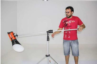
**Descrição:** o contra peso da girafa é um acessórios incluso do produto. Ele o modelo de girafa utilizado na análise possui um contra peso de 3kg, e é utilizado contrabalancear o peso refletor. Em formato cilíndrico, o contra peso pode ser ajustado através da sua posição na haste, e ser fixado através do sistema de rosqueamento.
