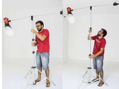
**Tarefa:** O tripé possui duas hastes internas, oferecendo assim, três níveis de alturas para a girafa. Com as duas mãos o usuário pode regular a altura desejada da girafa;
