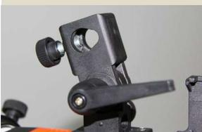
**Descrição:** o encaixe do refletor, será feito através do pino da extremidade da haste com o dispositivo de encaixe do próprio refletor;
