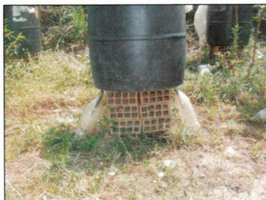
Figura 3.8. Lisímetro e os respectivos drenos.
