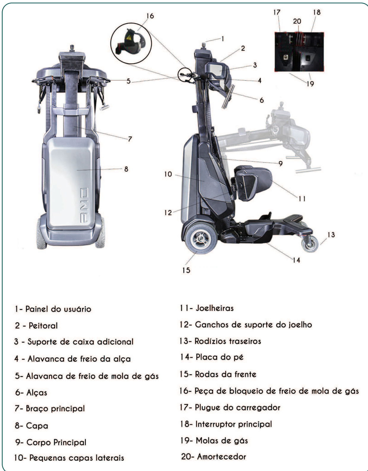
Figura 07: Componentes do TEK RMD
