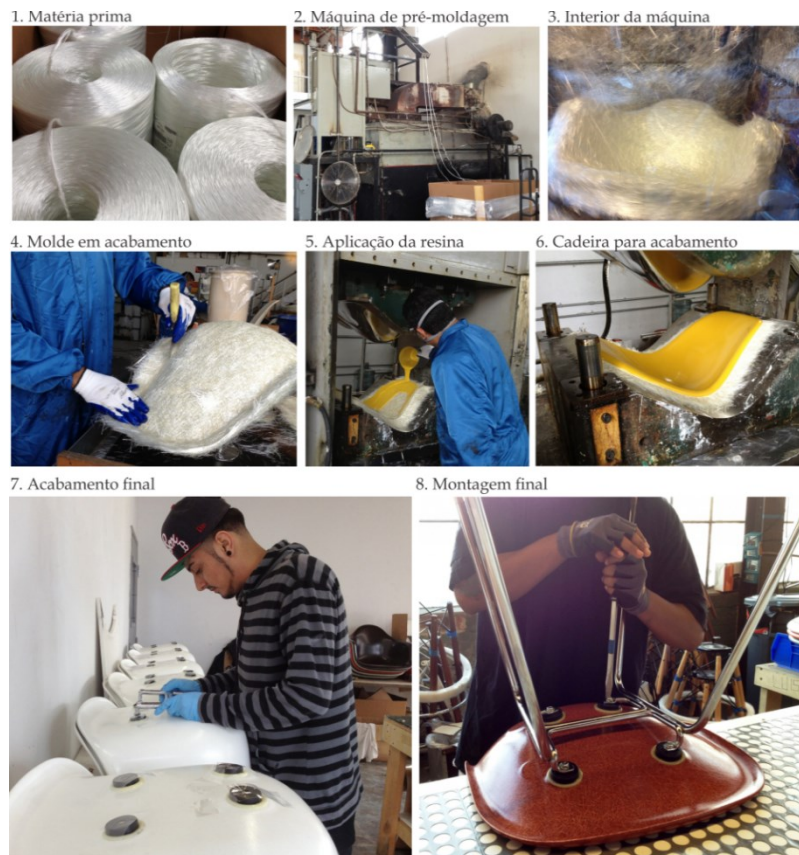
Figura 32: Fabricação da fibra de vidro.
