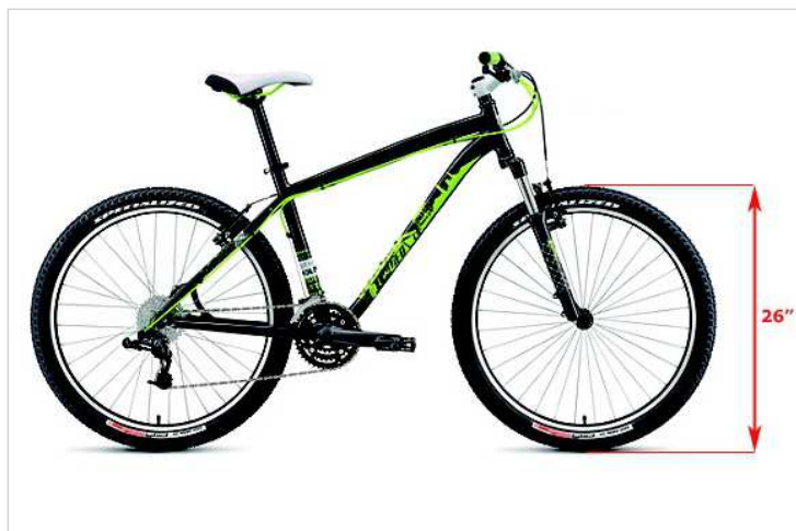
▲ Figura 26: Dimensionamento do pneu de uma Mountain bike. (Fonte: Escola de Bicicleta).
