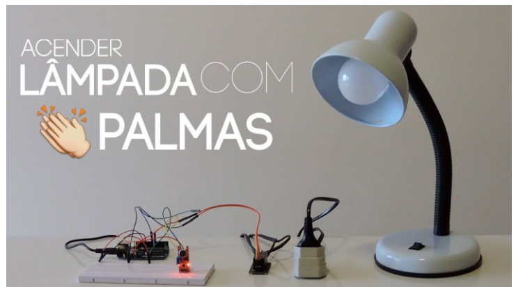
Figura 40 Sistema elétrico acionado pelo controle de som
