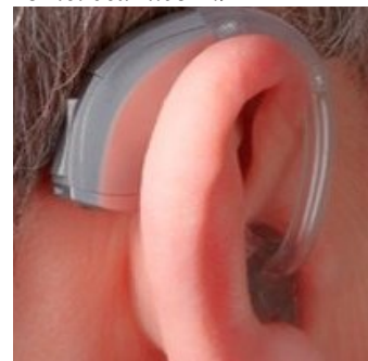
Figura 27 Aparelho auditivo retroauricular (BTE) Rexton.
