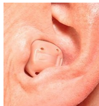
Figura 25 Aparelho auditivo intracanal (ITC) Rexton.
