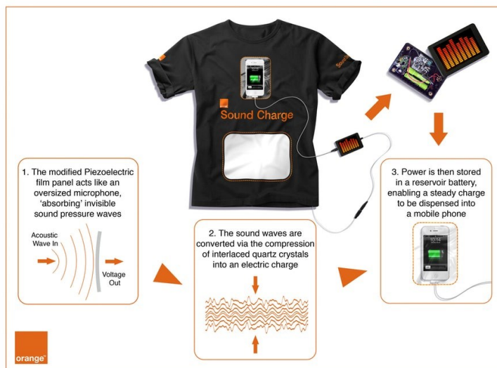
Figura 22 Funcionamento da Sound Charge
