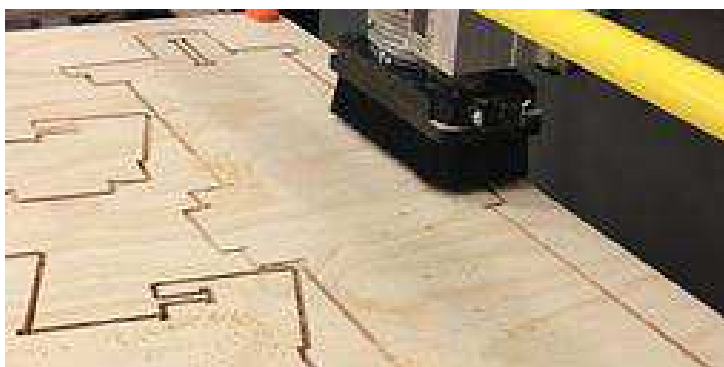
▲ Figura 108: Corte a laser em madeira. Fonte: goo.gl/TJpcuk
