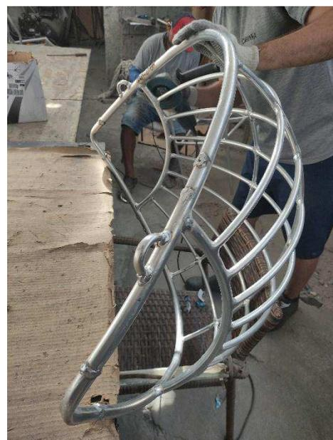
Figura 81 - Processo de acabamento com lixadeira automática (Fonte: Autor, 2022)
