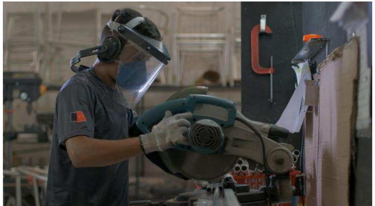
Figura 21 - Alumínio em processo de corte (Fonte: Arquivos Cabanna).
