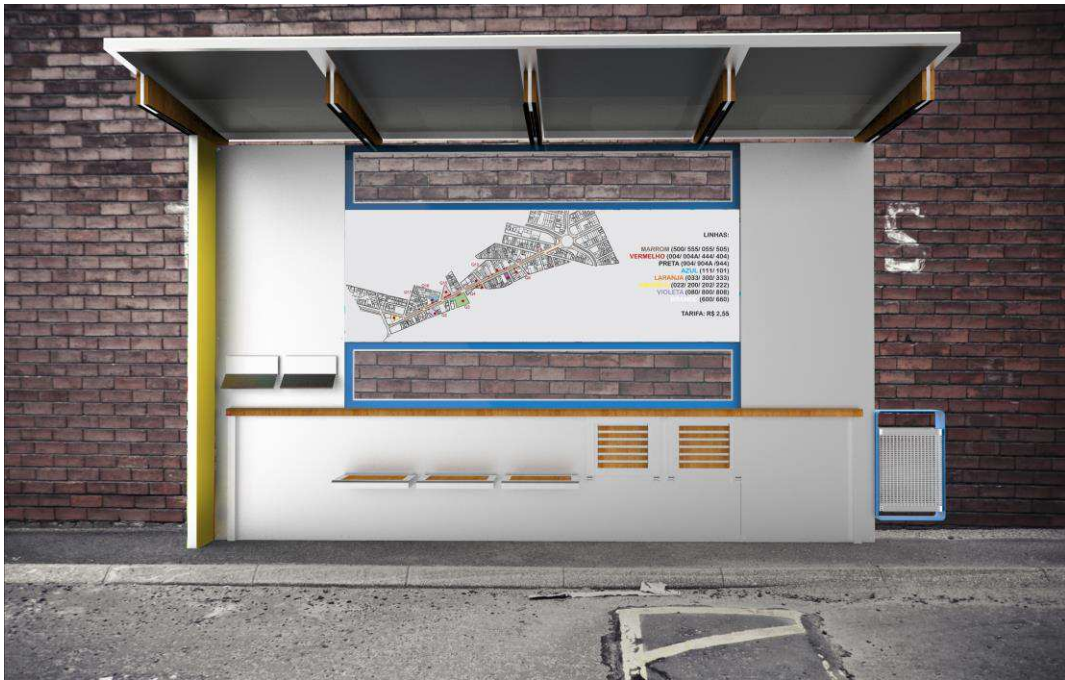
Figura 44: Abrigo com acabamento em placas de aço galvanizado.
