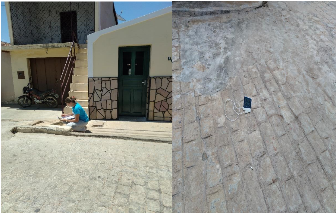
Figura 14 - Termo-higrômetros instalados a pleno sol para medição da temperatura e umidade relativa do ar na cidade de Pombal-PB
