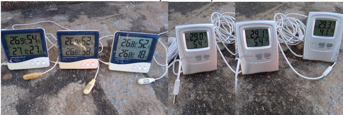
Figura 12 - Termo-higrômetros modelos INCOTERM usados para medir a temperatura e umidade relativa do ar sob a copa da árvore e a pleno sol.
