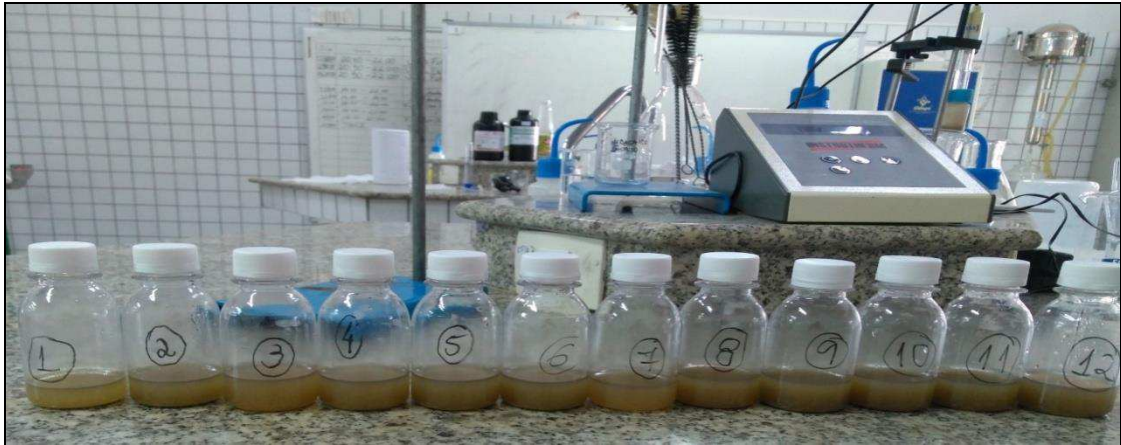
Figura 4.6 - Filtrados resultantes da cinética de adsorção.
