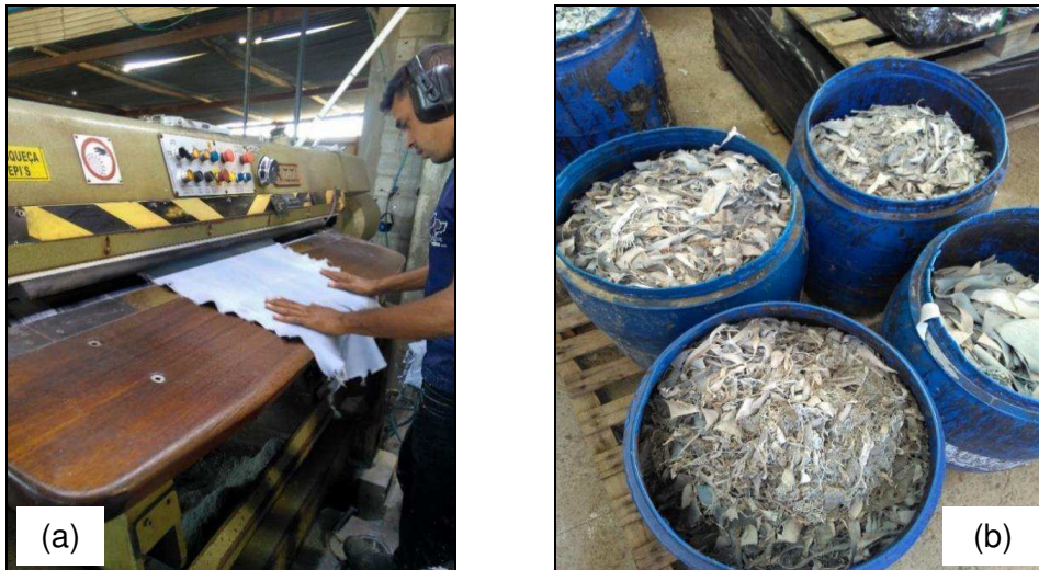
Figura 3.5 – Rebaxadeira (a); Resíduos de aparas de couro wet-blue (b).
