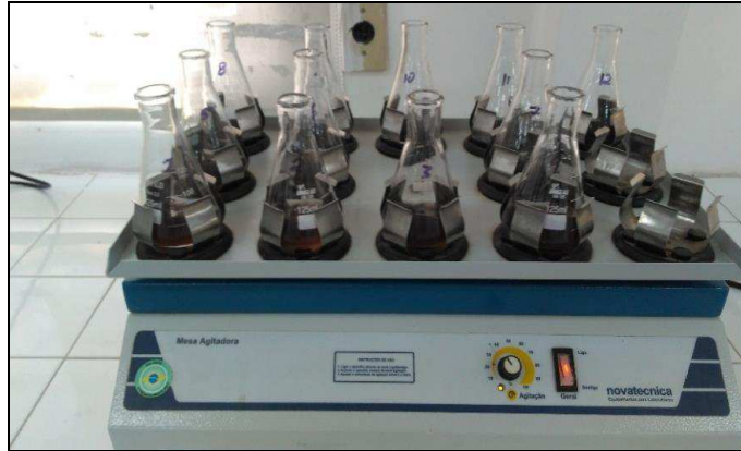
Figura 4.5 - Mesa agitadora para obtenção das curvas cinéticas de adsorção.
