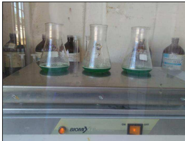
Figura 3.9 - Quantificação do teor de \text{Cr}_2\text{O}_3 nos resíduos de couro wet-blue .
