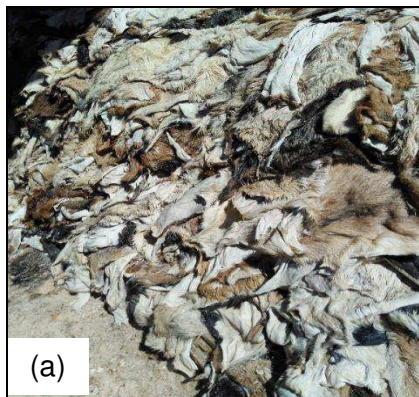
Figura 1.3 - Matéria-prima e pele curtida: Pele “verde”, recém-chegada ao curtume (a); Couro wet-blue (b).
