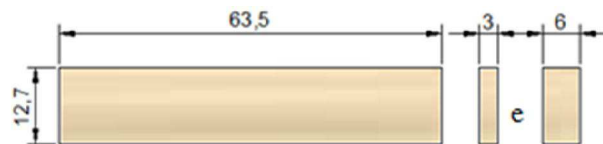
Figura 3.9 – Dimensões (mm) dos corpos de prova de impacto
