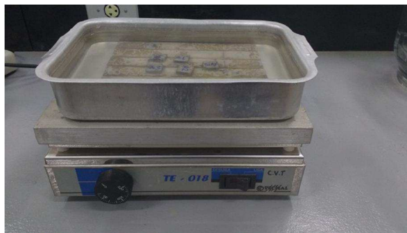
Figura 3.12 – Amostras no interior do banho térmico durante ensaio de sorção de água
