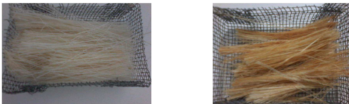
a) b) Figura 4.4 - Aspecto das fibras de sisal a) antes e b) depois da secagem a 105°C.
