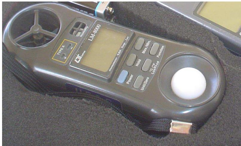
**Figura 11** *LM 8000 Lutron* (luminosidade e velocidade do vento)
