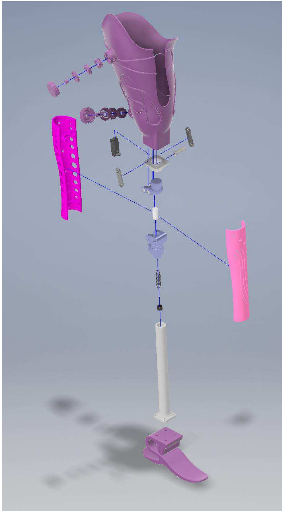
Figura 64: Vista explodida da nova prótese transfemural infantil modelada
