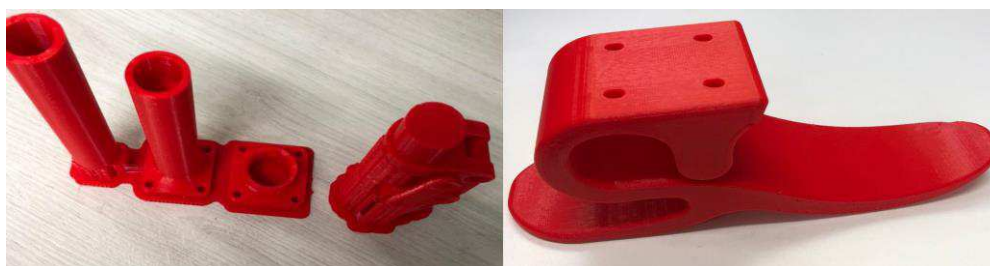
Figura 82: Pé Niagara, Tibia Tubular, Joelho por MA
