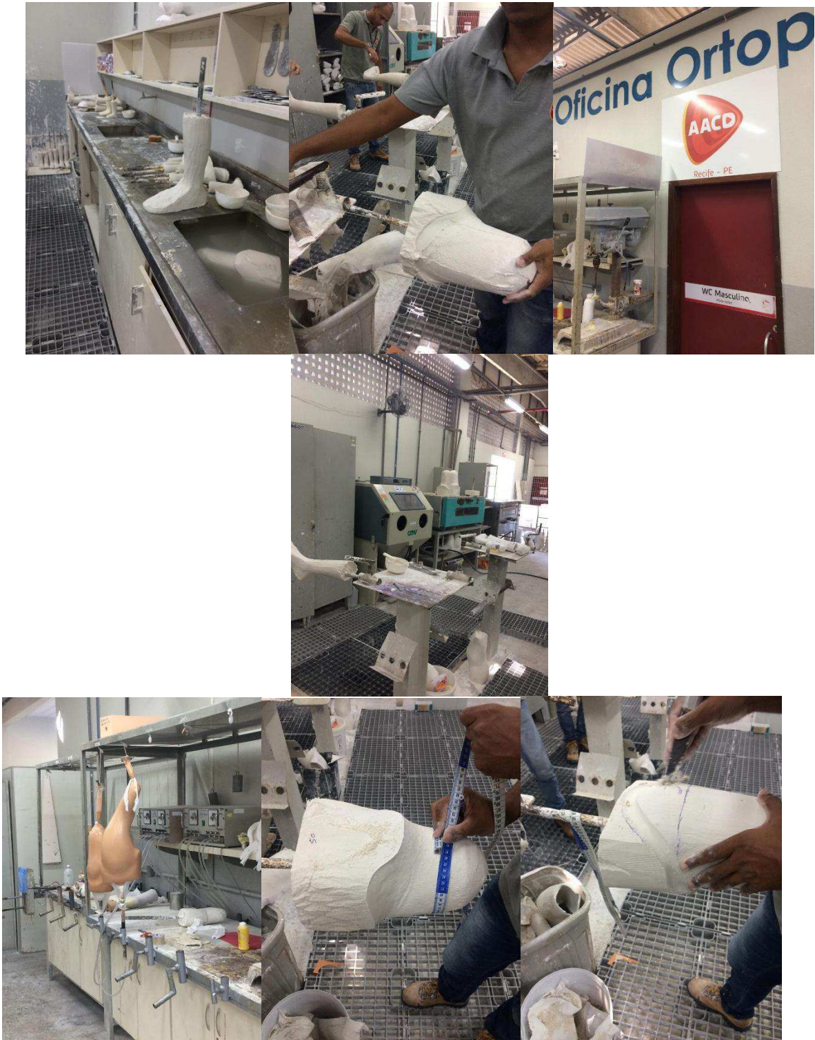
Figura 44: Registros da fabricação tradicional de prótese transfemural no centro ortopédico da AACD – Recife
