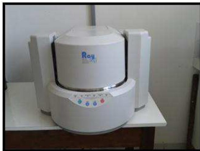
**Figura 3.3-** Espectrômetro de fluorescência de raios X
