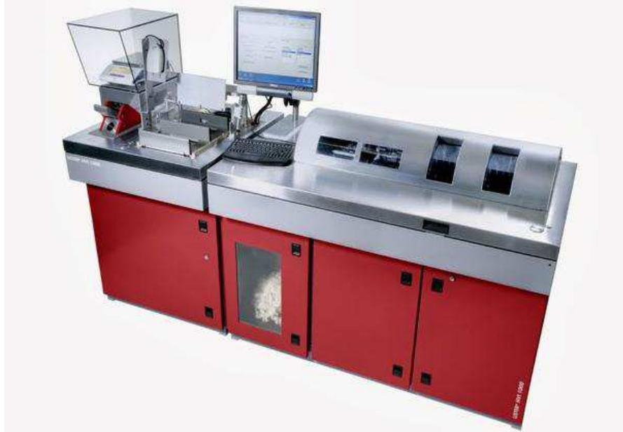
**Figura 14:** HVI (High Volume Instruments) modelo 900 da Spinlab/Zellweger Uster e AFIS (Advanced Fiber Information System). Utilizado para medir as características intrínsecas da fibra
