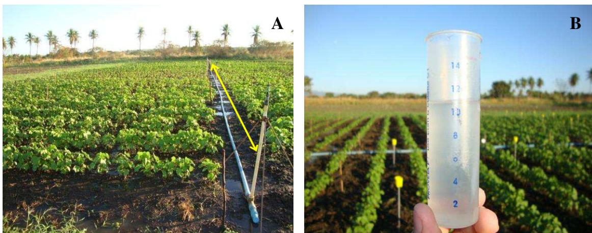
**Figura 12:** A e B Espaçamento entre os aspersores e quantificação das lâminas de irrigação por meio de pluviômetro.
