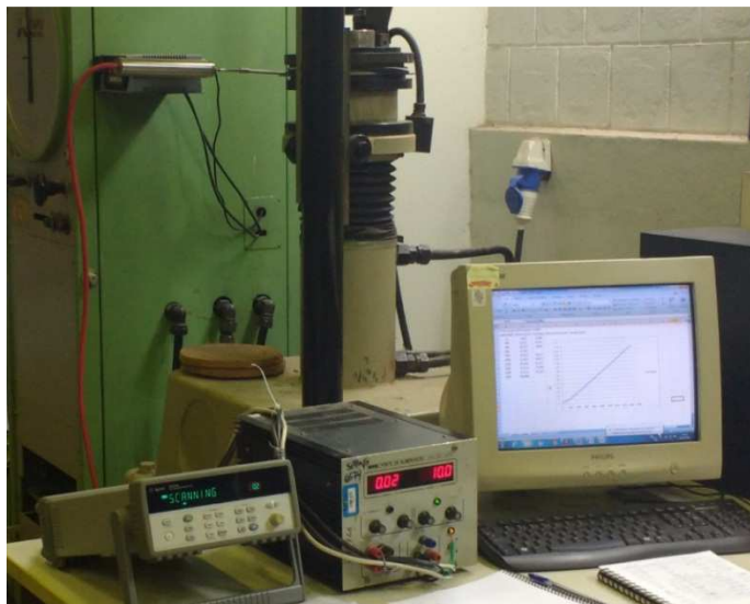
Figura 39. Montagem do equipamento para calibração das células no laboratório.
