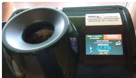
Figura 32. Medidor de umidade e temperatura: Modelo do equipamento (A); Resultados observados (B).
