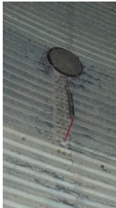
Figura 47. Detalhe do posicionamento das células na parede do silo: Detalhe do suporte de fixação (A); Célula instalada (B).
