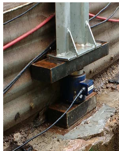
Figura 45. Placas que substituíram o suporte inicial das células: Configuração (A); Montagem (B).
