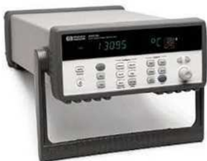
Figura 40. Sistema de aquisição de dados: Painel frontal (A); Portas de conexões e slots box (B); Slot (C).
